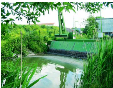
Vue sur le robot chargé d'épurer les canaux de leurs débris
